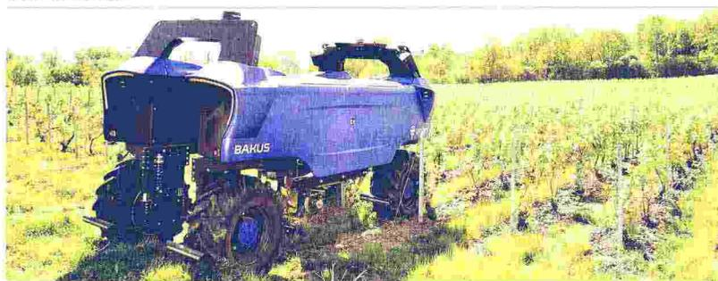
Un robot tra i vigneti. Motore elettrico e controllo da remoto. Sdf ha rilevato la maggioranza di Vitibot, Pmi francese specializzata in mezzi per la viticoltura
